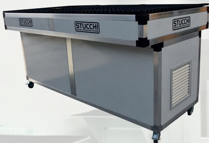
Banco aspirante per le lavorazioni di particolari di grandi dimensioni, il modello MI è adatto alle lavorazioni manuali di carteggiatura e alle lavorazioni tramite utensili abrasivi privi di aspirazione propria. Motore silenzioso, 75 dB, con piano di appoggio gommato antiscivolo ed anti graffio.
