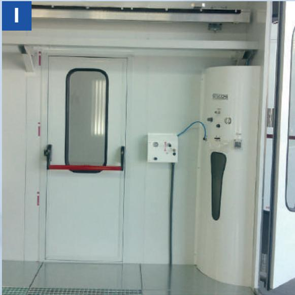
EL MODULO DE DISTRIBUCION DE ESQUINA UN PRODUCTO UTILIZADO COMO UNA CONEXION ENTRE LA UNIDAD DE SUCCION Y EL AREA DE OPERACION. ES POSIBLE CONTRUIRLO ENTRE LAS PAREDES DE LAS AREAS DE PREPARACION (1) O USARLO CON INSTALACION LIBRE (2)
