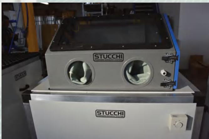
Un otro acesorio muy practico es el box de compresion totalmente hermetico, denominado MI Iron Box, una estructura muy similar a una maquina arenadora, con vidrio frontal para visionar las elaboraciones, guantes para poder coger las piezas de trabajar y lux exterior.
