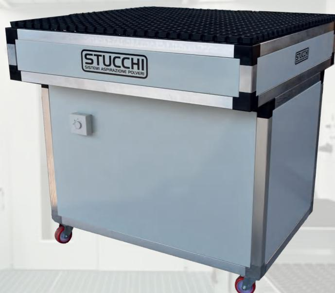
Banc aspirant pour les elaborations de particuliers, le modele MI Small est parfait pour les elaborations manuelles de ponçage et aux travaux avec outils abrasives sans une propre aspiration.
