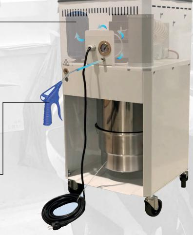
Avec le pistolet a air comprime est possible charger les reservoirs de ton STI-C.
